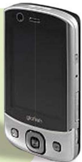
وقد تم تزويده بمعالج سامسونج SC3 6400 533 MHz بذاكرة بسعة 128 ميجابايت مع فتحة لتوسيعة بطاقة الذاكرة microSDHC ، وشاشة بقياس 2.8 إنش بتقنية TFT تستجيب للأوامر باللمس . وهناك منفذ للاتصال بتقنية Wi-Fi وبلوتوث من GPRS إلى جانب النظام العالمي لتحديد المواقع GPS . يعمل بنظام ويندوز موبايل 6 ويتسع DX900 بكاميرا رقمية بدقة 3 ميجا بكسل مع الفلاش ،
